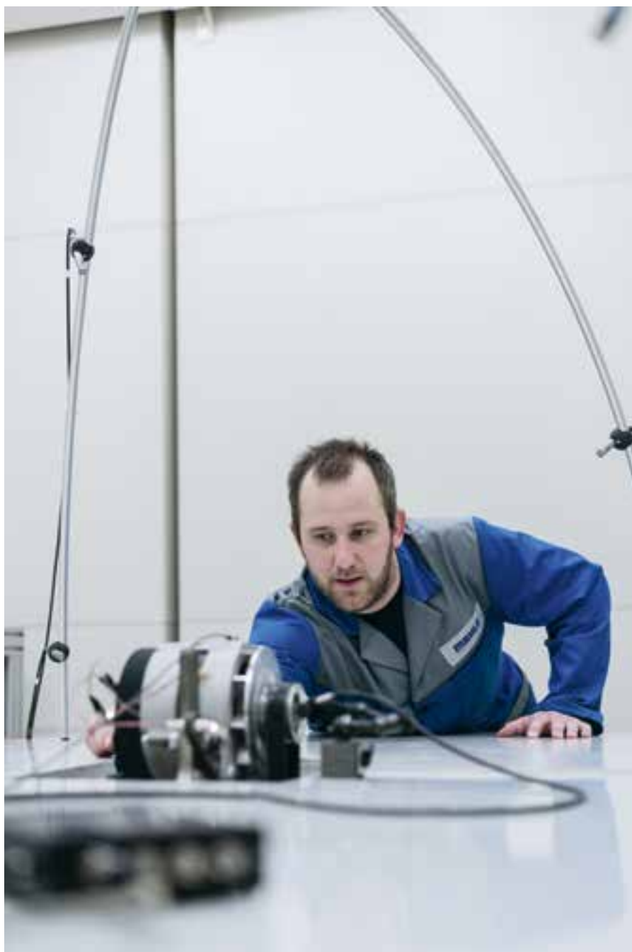
Hochsensible Mikrofone erkennen bei Generatoren störende Nebengeräusche.
