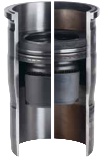
Vorher (links) und nach 1,2 Millionen Kilometern (rechts): Die MAHLE Komponenten hatten die lange Belastung unbeeindruckt überstanden.
