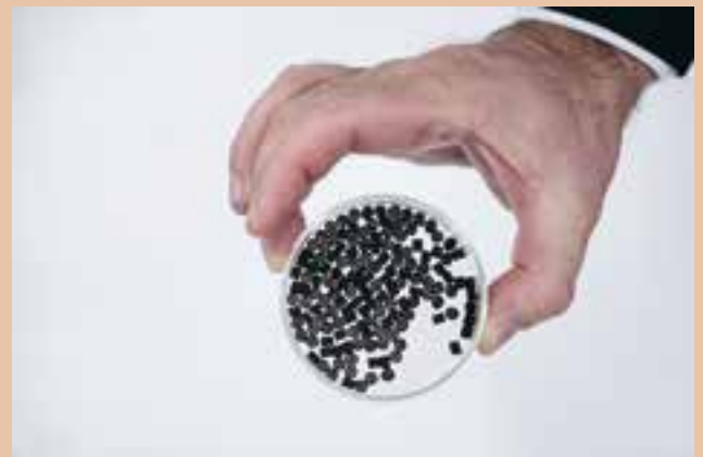
Formschön und effizient: Diese Aktivkohle-Stücke binden Benzindämpfe.
